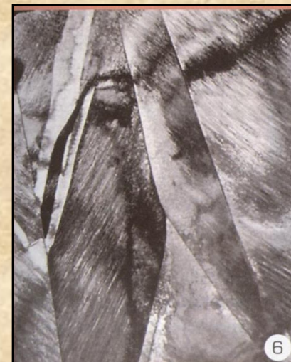
Struktura martenzytu płytkowego całkowicie zbliźniaczonego pow. 20 000x TEM
