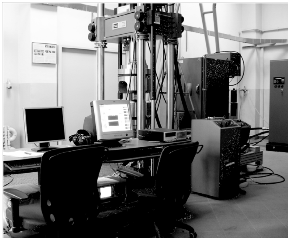
Fig. 10. Fatigue testing machine MTS 810 at Instytut Spawalnictwa in Gliwice
